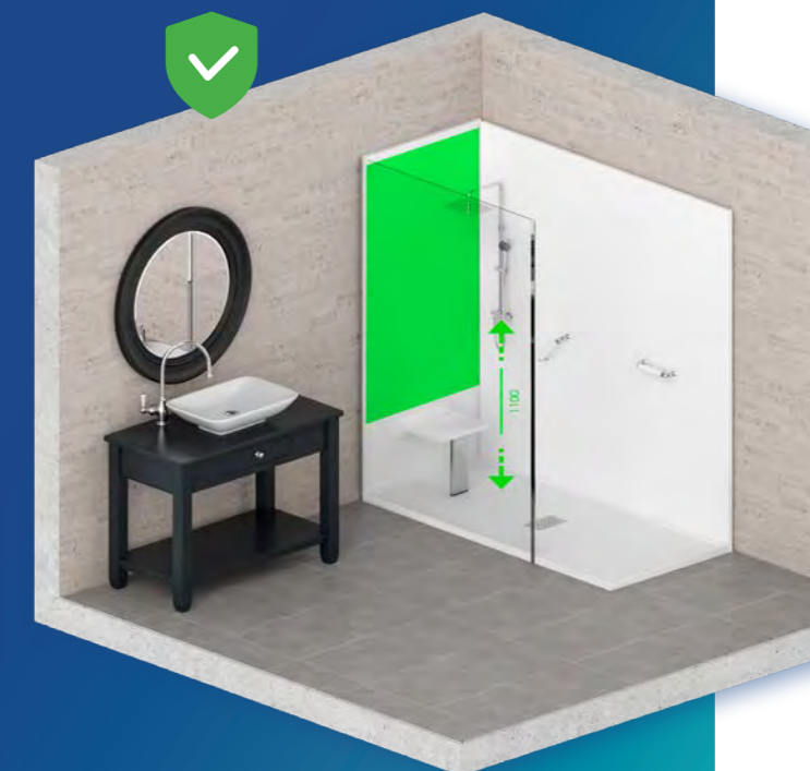
Positionnement adapté de la robinetterie
