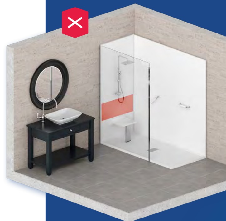
Positionnement non adapté de la robinetterie
